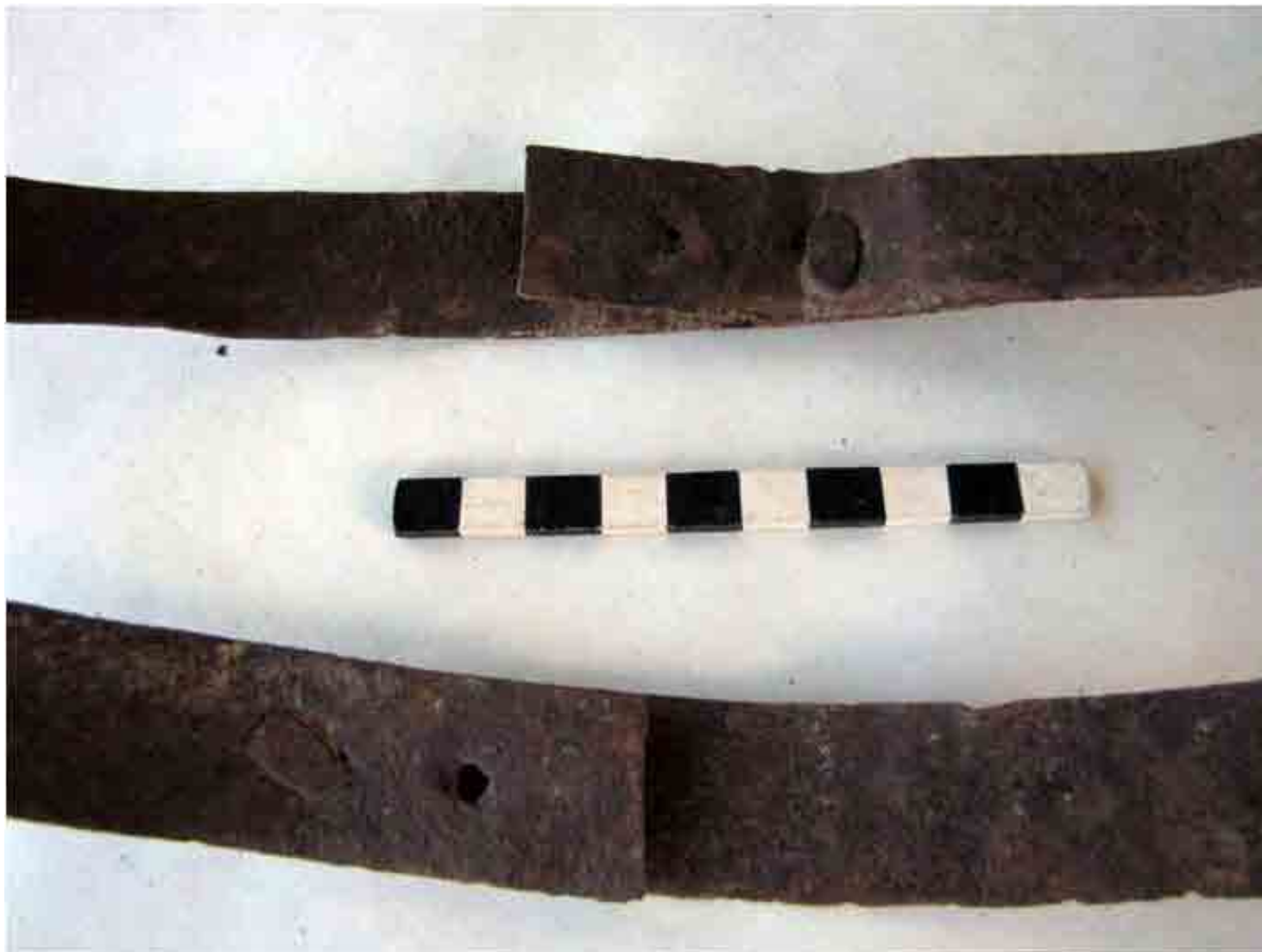
FIG. 90. Arreglos de sunchos mediante forjados simples en flejes de máquina de diferente ancho
