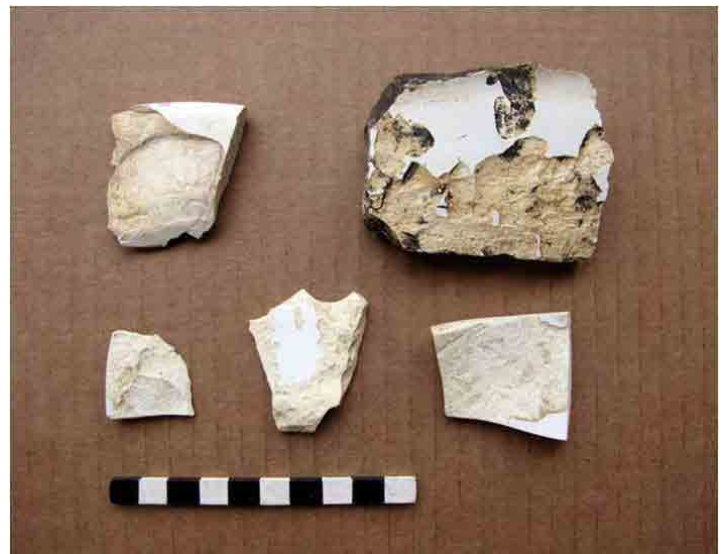
FIG. 10. Fragmentos de lozas altamente deteriorados por la exposición a la intemperie, que produjo la destrucción del esmalte y el lascado al moverse entre piedras
