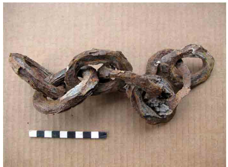
FIG. 62. Antigua cadena de uso náutico proveniente de la barranca de la costa, con eslabones forjados
