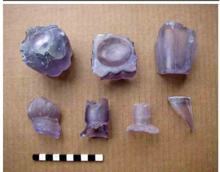
FIG. 11. Vidrio transparente que ha adquirido tono violeta, posiblemente por efecto de la luz ultravioleta de la intemperie, tema sólo observado en la Patagonia
