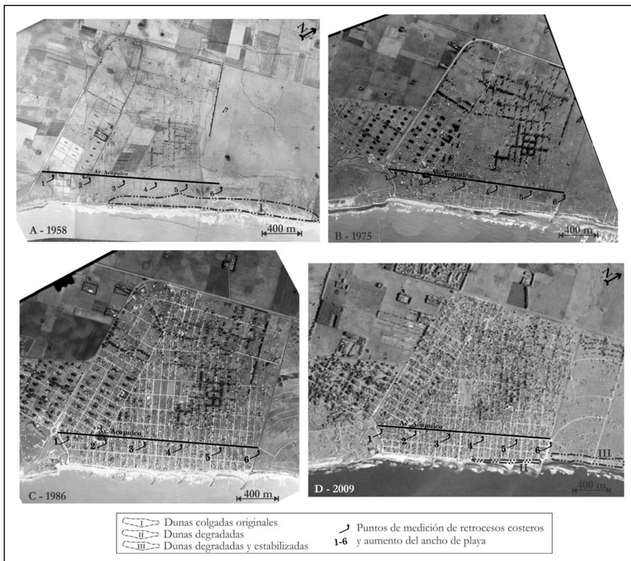
Figura 2. Comparación de la evolución de la localidad de Santa Clara del Mar a través de las fotografías aéreas de 1958, 1975 y 1986 del Departamento de Geodesia de La Plata y la imagen satelital Google Earth de 2009. Se observa la distribución a lo largo de la Av. Acapulco de los puntos de medición. Nótese el desarrollo de dunas colgadas (I) en el año 1958 sobre la costa de Santa Clara y Camet Norte, su deterioro en 2009 (III) y estabilización posterior (III) como consecuencia del avance urbano. Se puede observar el aumento progresivo de la playa producto de la instalación de los distintos espigones de defensa, especialmente entre los años 1975 y 1986.
