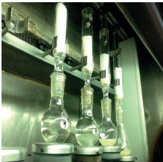
*Imagen 2: Muestras de soja molida en cartuchos para extraer materia grasa, mediante extractor Butt*
