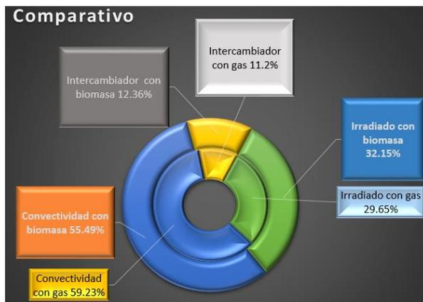
Fig. 7: Comparación entre irradiación, convectividad y calor intercambiado por la estufa utilizando ambos combustibles.
