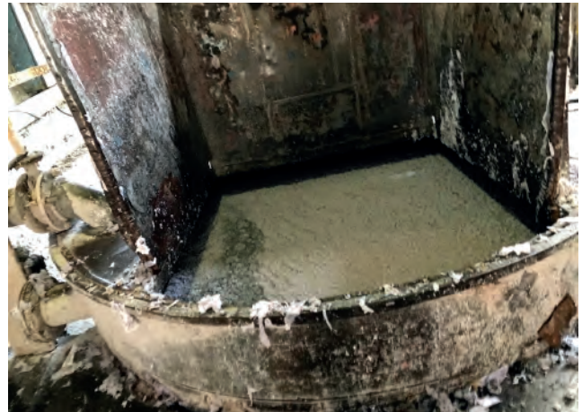
Ilustración 4: Pulper vacío donde se cargan insumos para papel higiénico. Fotografía propia.
