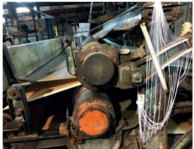
Ilustración 12: puesto del 3er. ayudante, con piolines que guían la pasta. Fotografía propia
