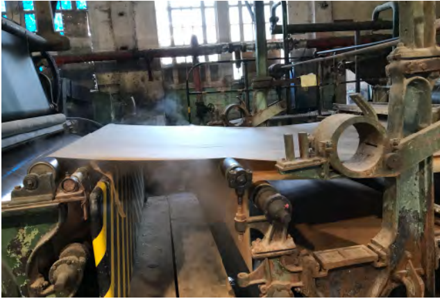
Ilustración 9: Lugar de transferencia del sector prensado al de secado. Fotografía propia.
