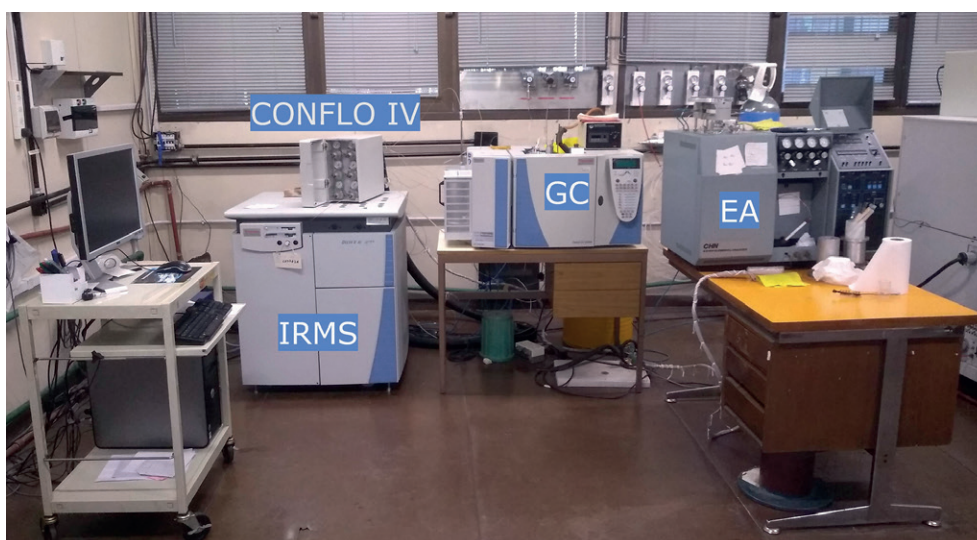
Figura 3. Equipo disponible en INGEIS para la medición de valores de \delta^{13}\text{C} y \delta^{15}\text{N} en materia orgánica.
