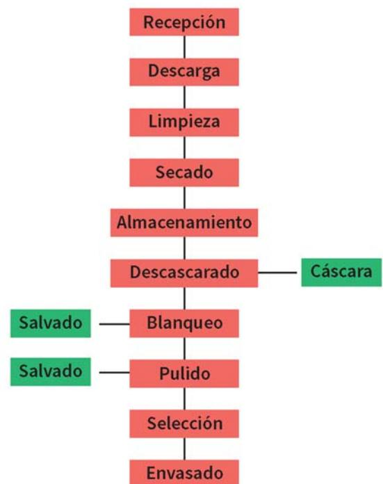
**Figura 4** - Balance de materia en el proceso de elaboración de arroz
