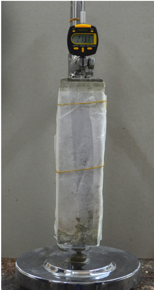
Fotografía 1: Medición del cambio de longitud debida a la RAS en probetas almacenadas según IRAM 1700.
