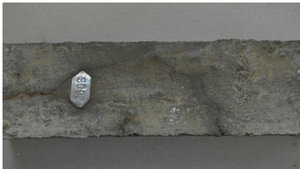
Figura 4: Expansiones de hormigones con 50% de AGR estacionados en cámara húmeda.
