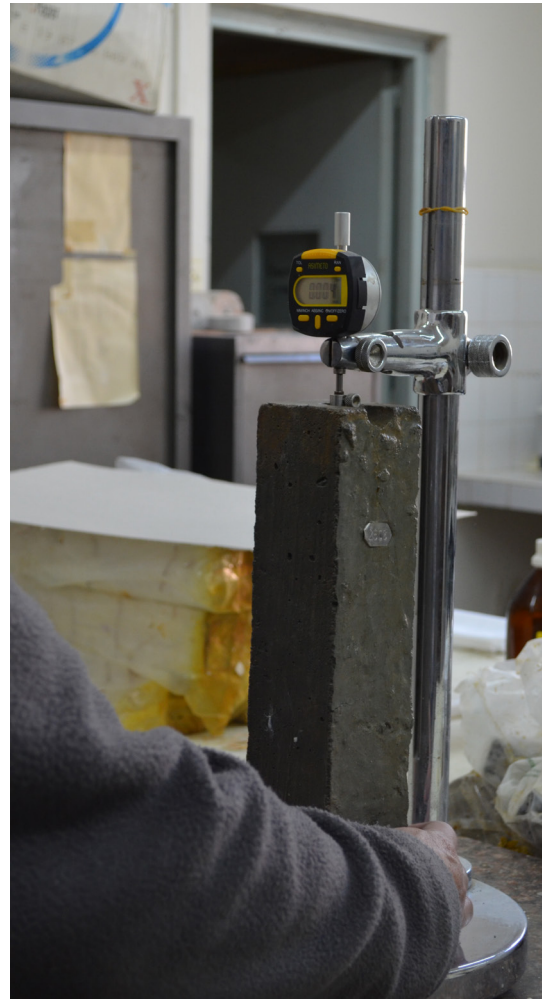
Fotografía 2: Medición del cambio de longitud debida a la RAS en probetas almacenadas en cámara húmeda.
