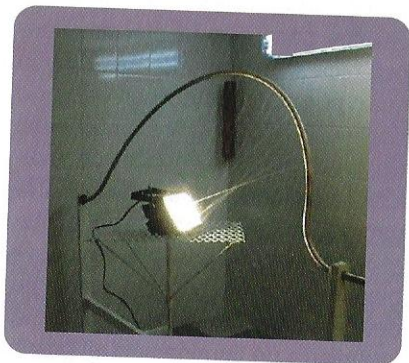
Figura 3.- DLLYU: Seguridad de luminarias. Prueba de lluvia
