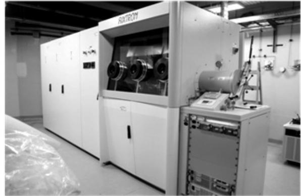
Figura 1: Reactor MOCVD montado en el laboratorio de crecimiento epitaxial.
