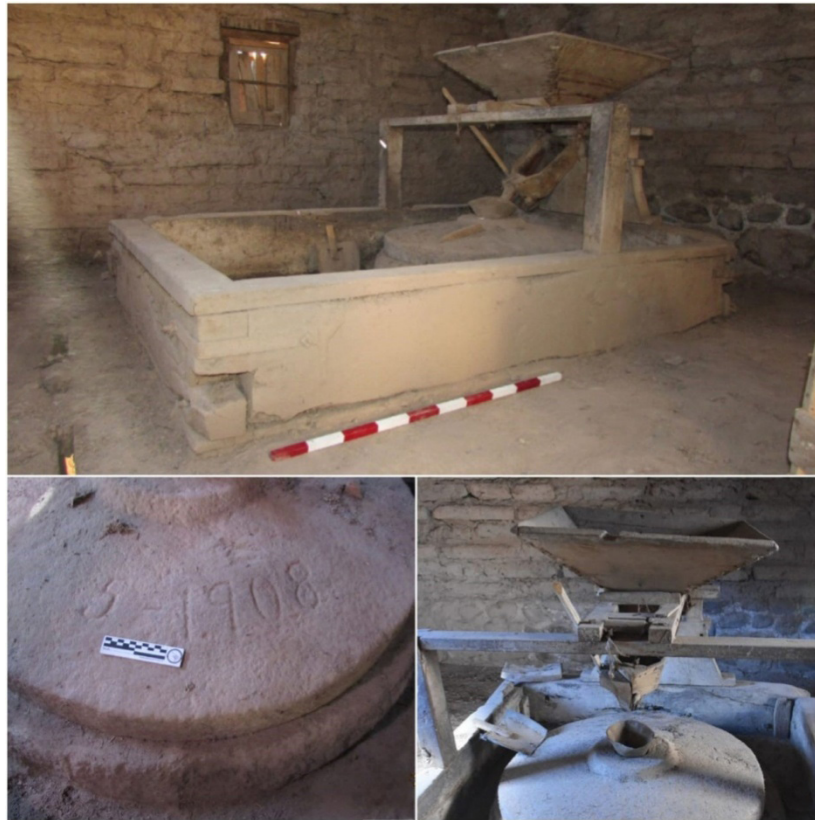
Figura 3. Diferentes partes de la maquinaria de molienda. Grabado de la fecha en la muela volantera.
