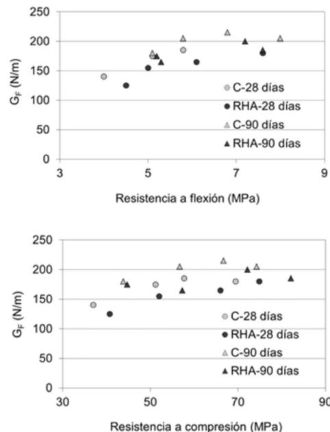
Figura 6. Variación de la energía de fractura en función de la resistencia.
