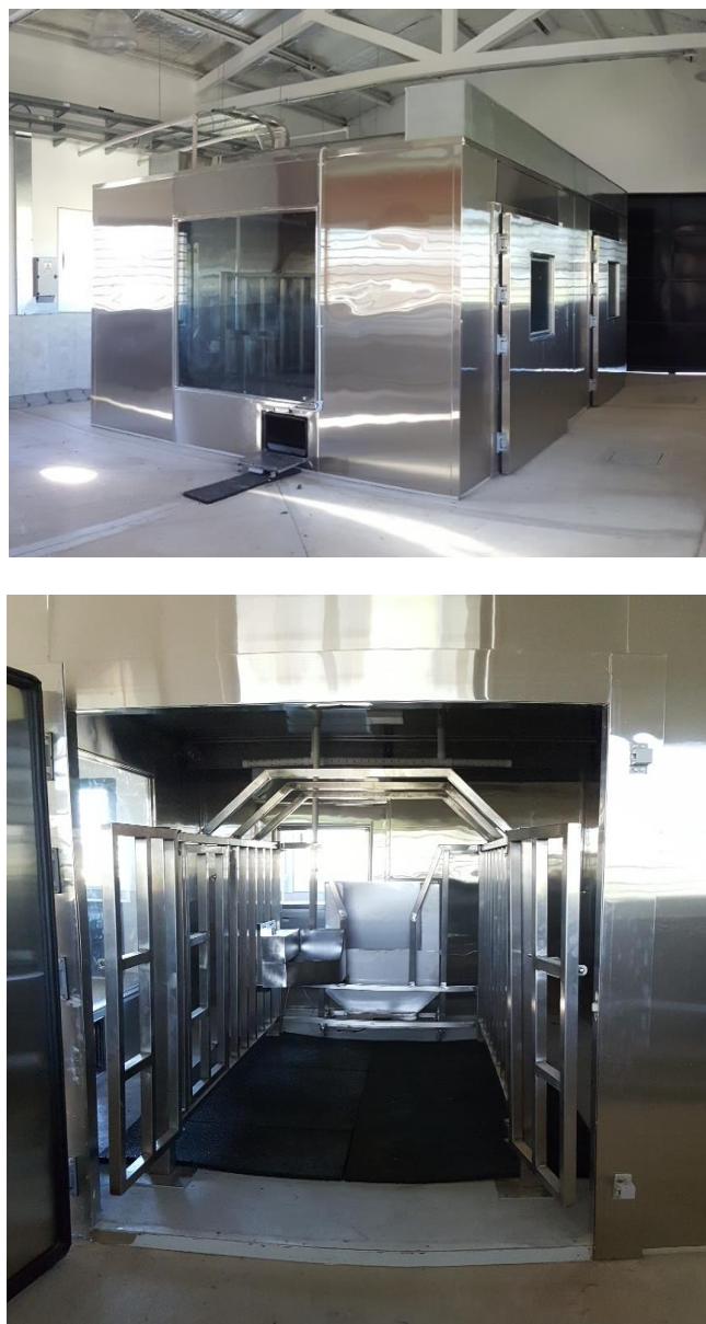
Figura 3.1. Vista exterior (superior) e interior (inferior) de las cámaras de respiración para medición de emisiones de metano, instaladas en INTA EEA Balcarce
