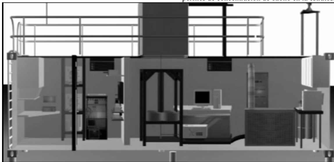
Figura 1. Corte transversal del contenedor-laboratorio ubicado en Río Gallegos y que alberga los distintos lidars y radiómetros.
