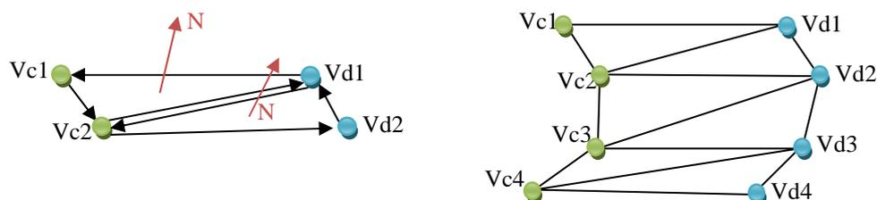
Figura 7. Generación de la malla de superficie: formación de triángulos y dirección de normales (a), porción de la malla de triángulos (b)
