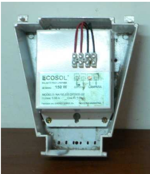
Fig. 2: Bandeja porta equipo auxiliar de la luminaria equipada con Balasto electrónico con regulación de tensión de salida y flujo luminoso escalonado pre-ajustado.
